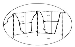
Fig.5. Pore microroughness parameters
